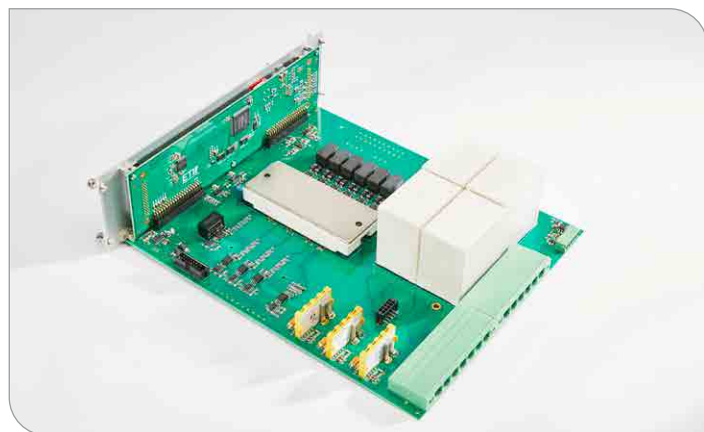
Dreiphasiges Modul eines zweistufigen Frequenzumrichters mit einer Leistung von 25 kW
