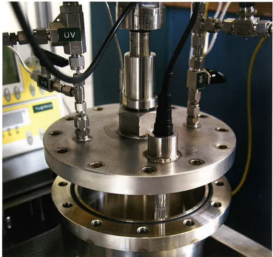
Druckbehälter zum Bestimmen von Löslichkeiten: An der Versuchsanlage am Engler-Bunte-Institut des KIT untersuchen Wissenschaftler die Löslichkeiten von Kohlenstoffdioxid und von Methan in Fermentationsflüssigkeit.
